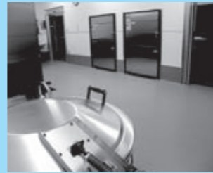
▲パススルー真空冷却機 (和え物室側)
