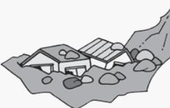
斜面の一部あるいは全部が地下水の影響と重力によってゆっゆりと斜面下方に移動する現象。
