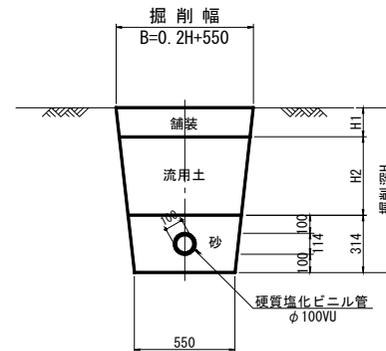
小口径汚水柵及び取付管舗装工計算書
