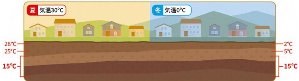
地中熱の利用には、地中熱ヒートポンプ等を用います。地中熱ヒートポンプとは、大地とヒートポンプを組み合わせた冷暖房・給湯システムです。
