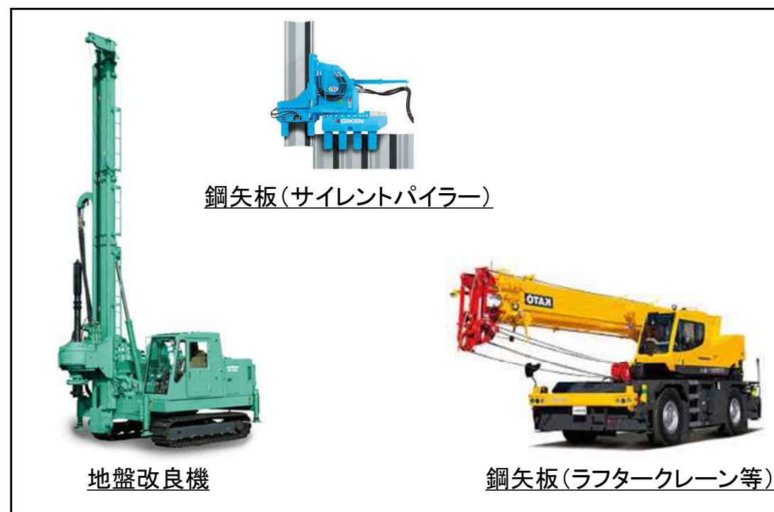
主な施工重機
