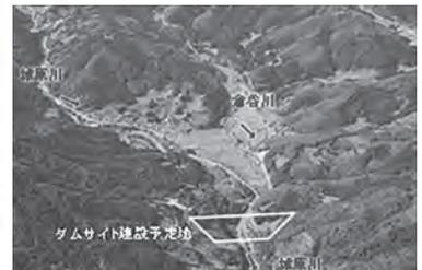
底の部分に穴が空いており、普段は水を貯めず、大雨時のみダム湖内に一時的に洪水を貯留します。
