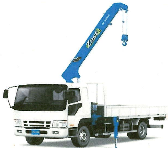
ユニック車: 資材の運搬・吊り荷作業に使用
