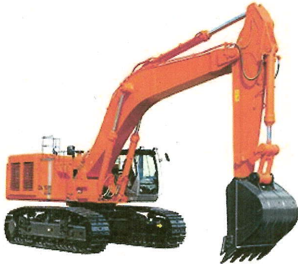
バックホウ:土の掘削に使用
