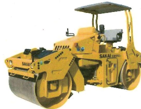
ロードローラー:土の締固め(転圧)に使用
