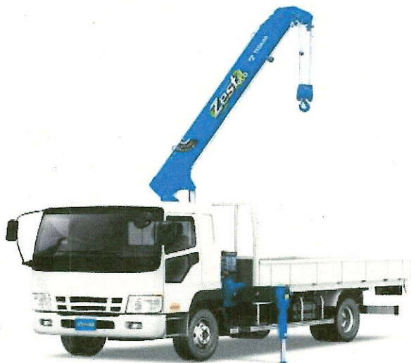
ユニック車: 資材の運搬・吊り荷作業に使用
