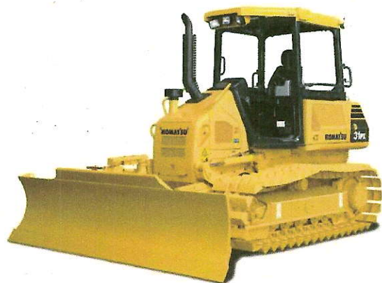
ブルドーザー: 土の押土に使用
