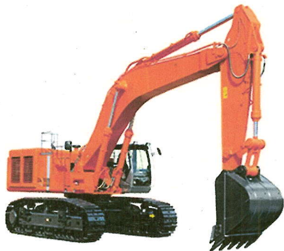
バックホウ: 土の掘削に使用
