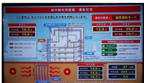
地中熱ヒートポンプシステム（市役所）
