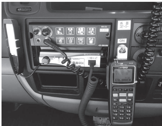
消防団の小型動力ポンプ積載車に搭載されている車載型MCA無線機
