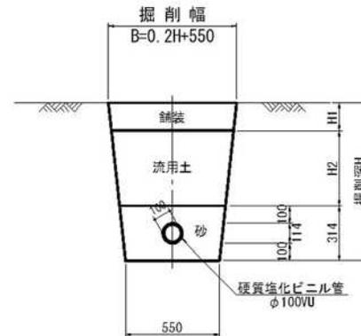
道路内掘削深=道路地盤高a-(柵設置地盤高①-柵深②)+0.10m
