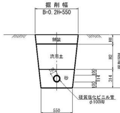
道路内掘削深=道路地盤高a-(柵設置地盤高①-柵深⑩)+0.10m
