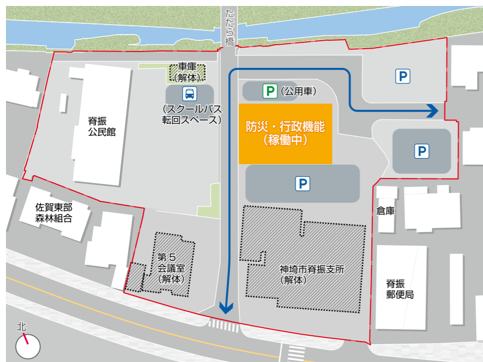
STEP 1-3 ・既存支所、第5会議室ほか 解体
