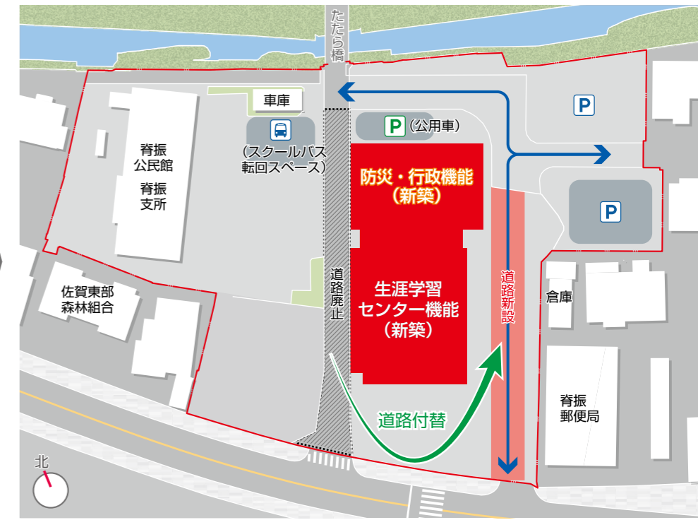
STEP 1-1 ・『防災・行政機能』『生涯学習センター機能』新築 ・市道整備（東側）⇒ 既存市道 廃止 ・外構工事 ※駐車場（一部）整備
