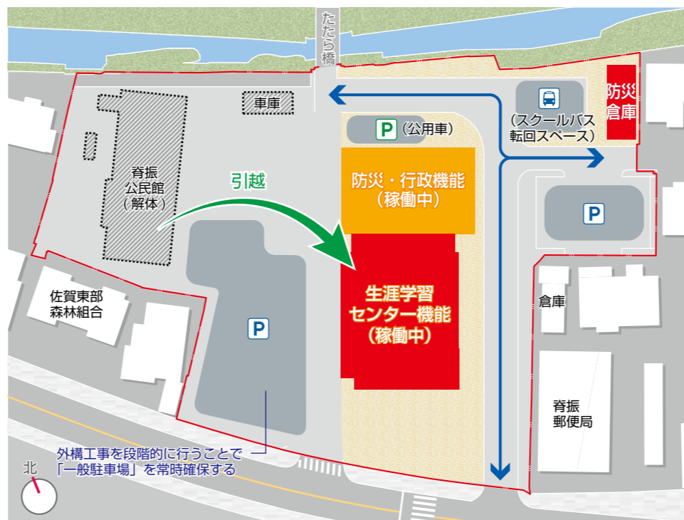
STEP 2 ・「生涯学習センター機能」新築 ・既存公民館より「生涯学習センター機能」へ引越し ・防災倉庫 新築 ・外構工事 ※スクールバス転回スペース等整備 ・市道整備（東側）⇒ 既存市道 廃止
