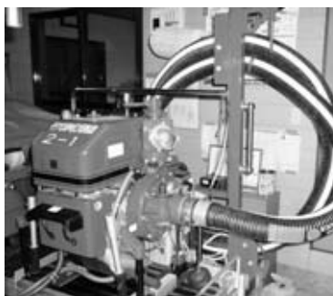
消防団車輛に積載されている可搬式ポンプ
