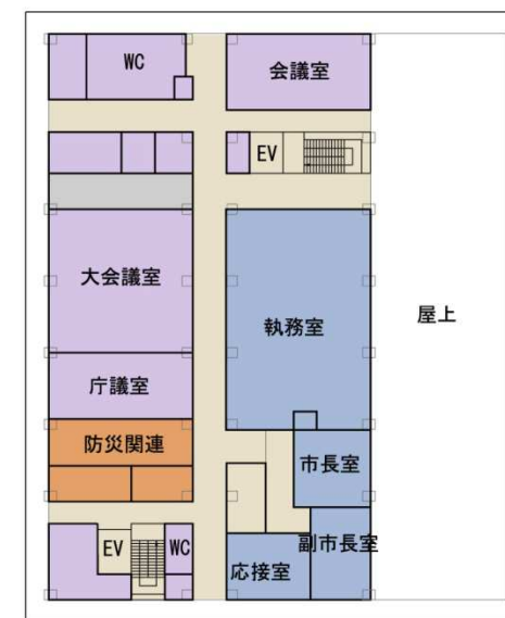
■ 3階（執務フロア） 災害時の迅速・的確な防災指揮のため、執行部エリアと防災機能を集約配置
